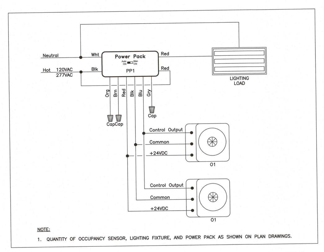
TYPICAL WIRING DIAGRAM FOR AUTO ON WITH NO LOCAL SWITCHING
